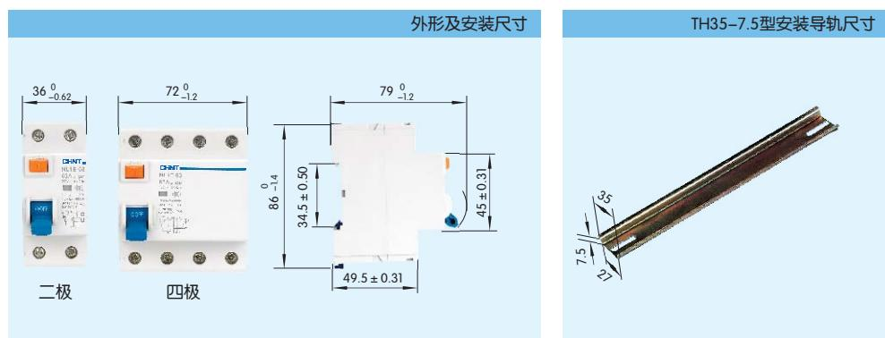
接线：端子接线面积25A及以下可接6mm<sup>2</sup>多股软线或单股硬线。
